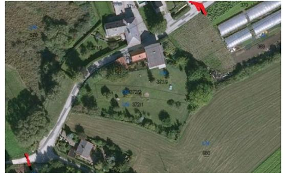
2) Der „**Hernstein Bach**“, der in der Dorfstraße in Neusiedl verrohrt ist, wird ab Kreuzung Dorfstraße – Zobelgasse mit einer zweiten Rohrleitung versehen. Damit wird der Abfluss bei starkem Niederschlag gewährleistet.
